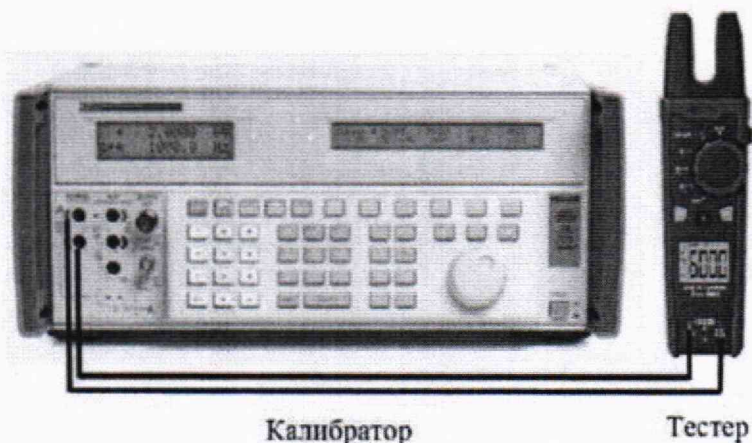
Рисунок 1 – Схема подключений для определения абсолютной основной погрешности измерений напряжения постоянного тока, абсолютной основной погрешности измерений напряжения переменного тока, абсолютной основной погрешности измерений электрического сопротивления постоянному току (положение поворотного переключателя режимов работы тестера показано условно)
