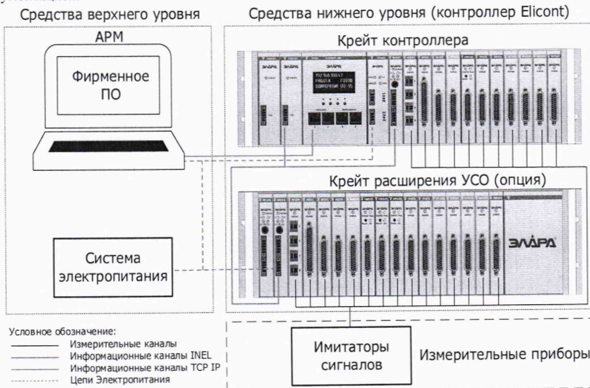
Рисунок 1 – Структурная схема стенда для поверки ИК
