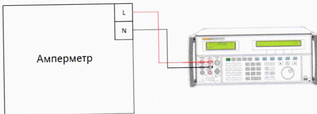
Рисунок 3 – Схема подключения для определения допустимой относительной погрешности измерений силы постоянного тока (для модификаций с однофазным входом сигнала постоянного тока) при значениях силы постоянного тока до 3 А
