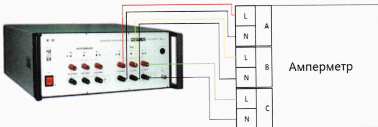
Рисунок 2 – Схема подключения для определения допускаемой относительной погрешности измерений силы переменного тока в диапазоне частот от 45 до 65 Гц (Для модификаций с трехфазным входом сигнала переменного тока)
