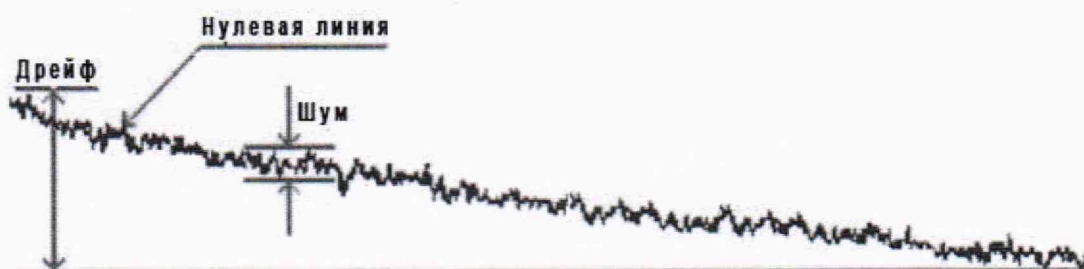
Рисунок 1 – Определение уровня флуктуационных шумов и дрейфа нулевого сигнала
