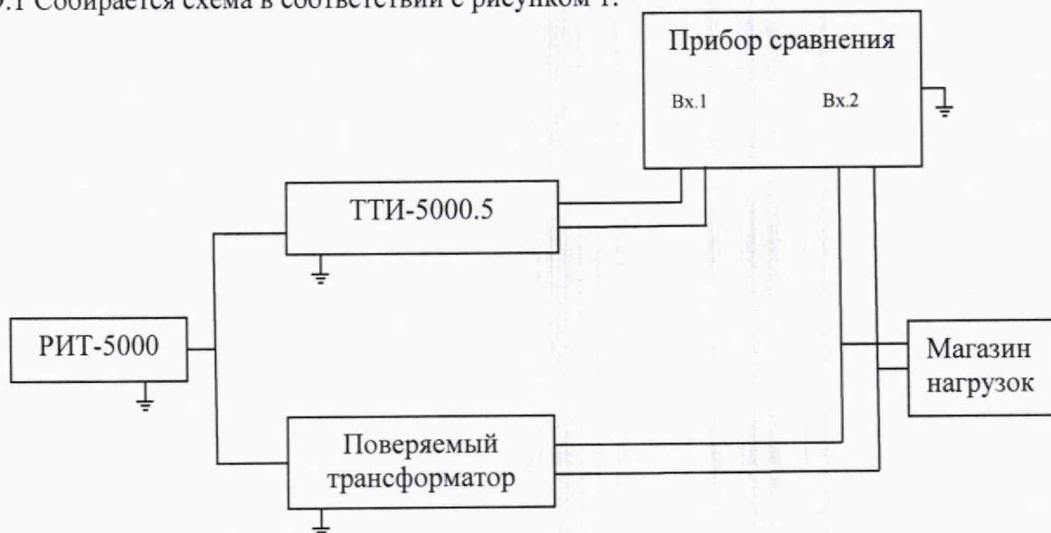
Рисунок 1 – Схема определения токовых и угловых погрешностей трансформаторов
