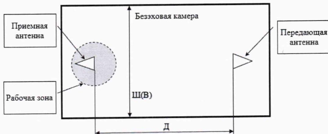
Рисунок 1 – К расчёту параметров перемещения антенн
