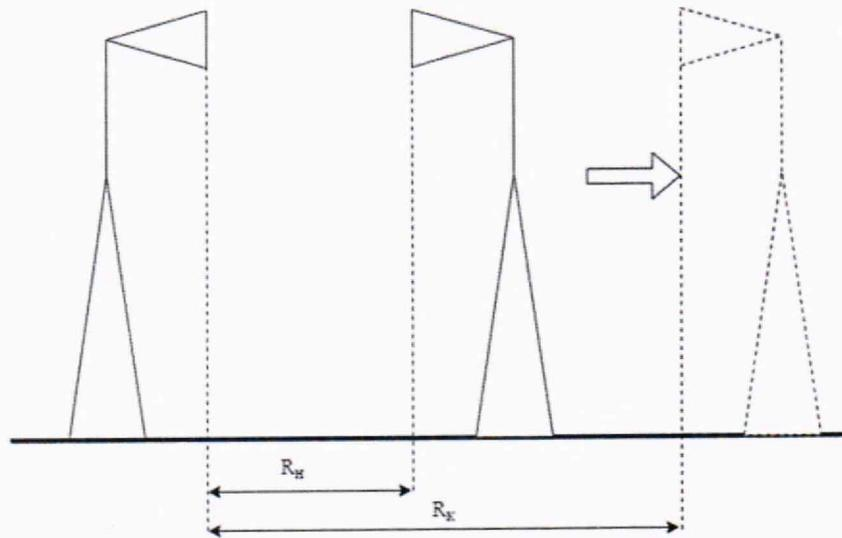
Рисунок 4 – Схема установки и перемещения антенн
