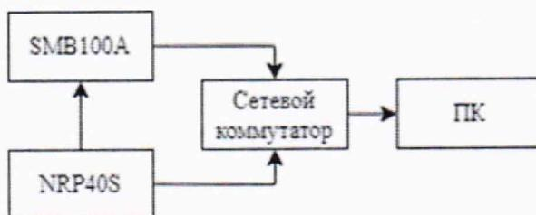
SMB100A – генератор SMB100A; NRP40S – ваттметр NRP40S; ПК – персональный компьютер
