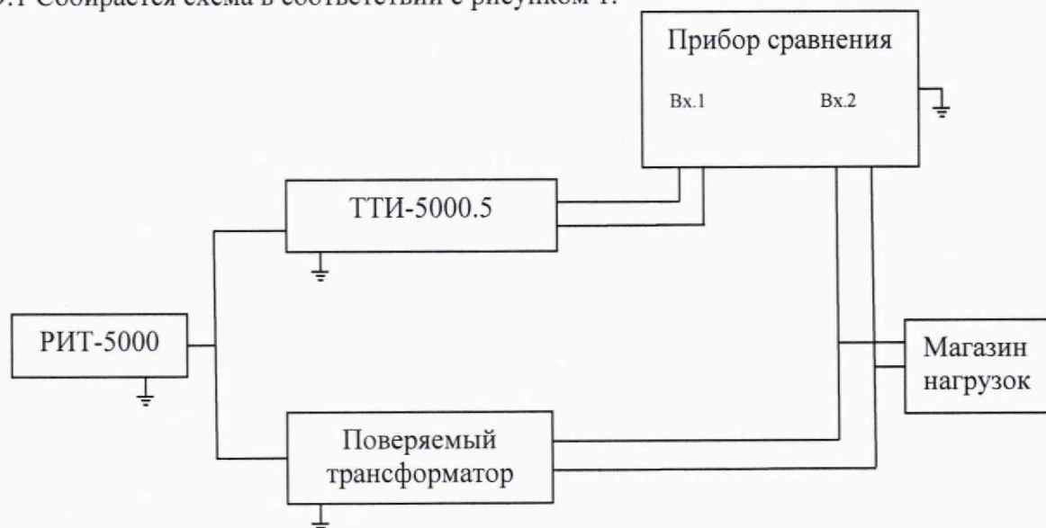
Рисунок 1 – Схема определения токовых и угловых погрешностей трансформаторов
