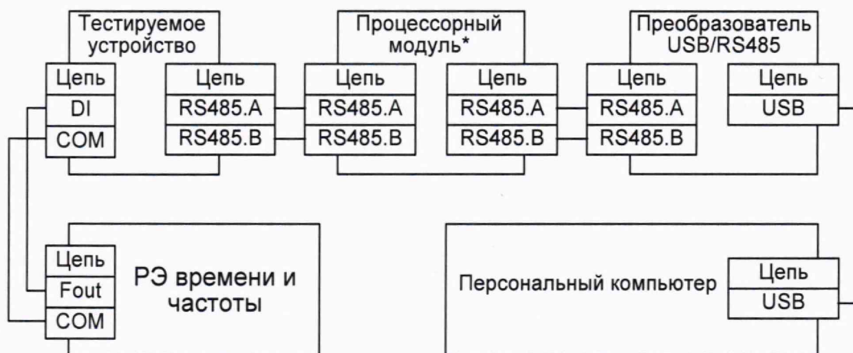
Рисунок Б.1 – Схема подключения устройств для поверки контроллеров Ария ver.4.5 АВПЮ.426441.358-10
