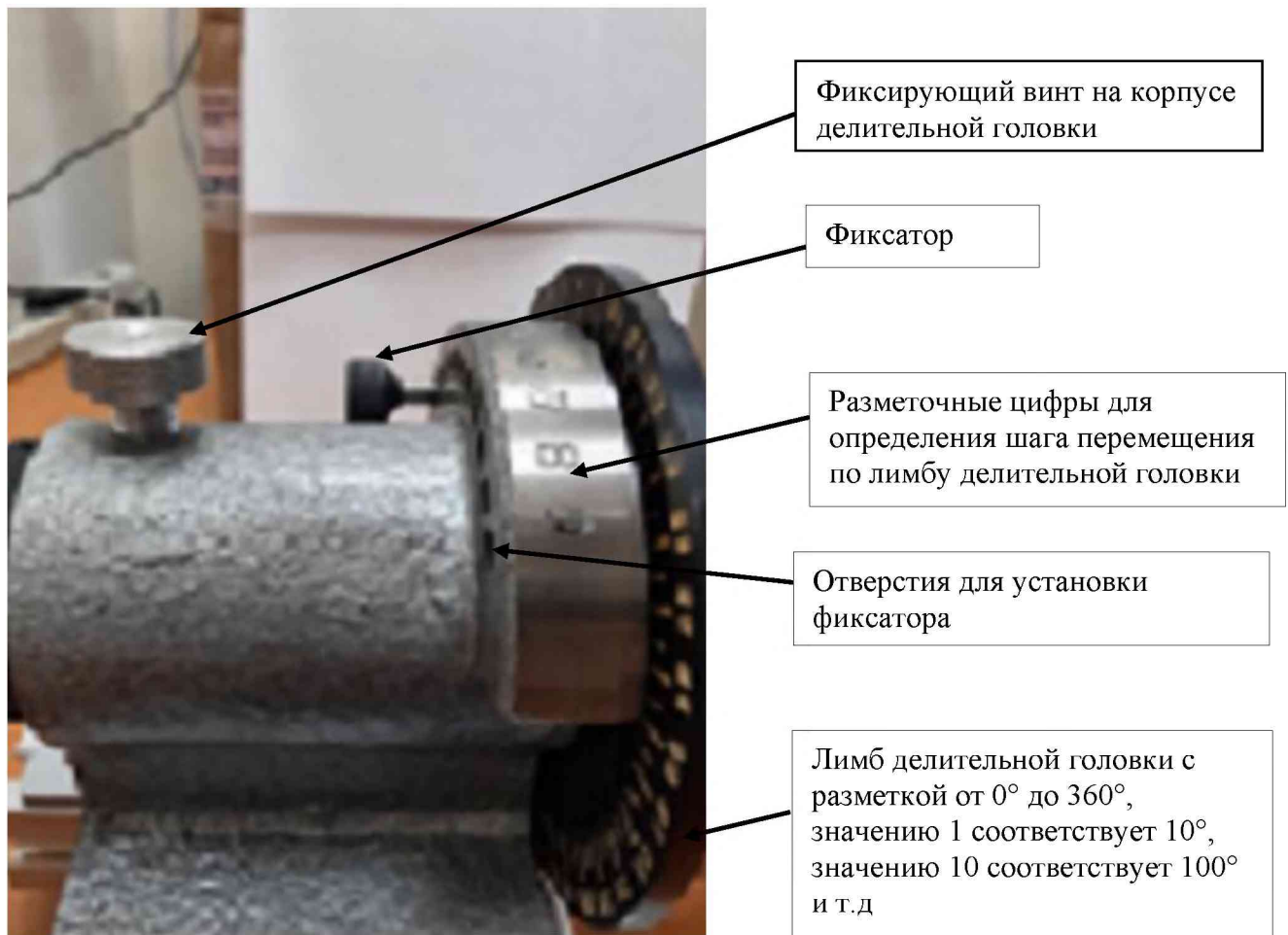
Рисунок – 29 Делительная головка
