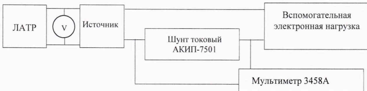
Рисунок 5 - Структурная схема определения нестабильности выходного сигнала силы постоянного тока, вызванной изменением напряжения питания
