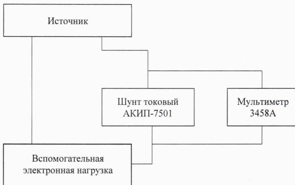
Рисунок 2 – Схема подключения источника при абсолютной основной погрешности воспроизведений и измерений воспроизведенных значений силы постоянного тока
