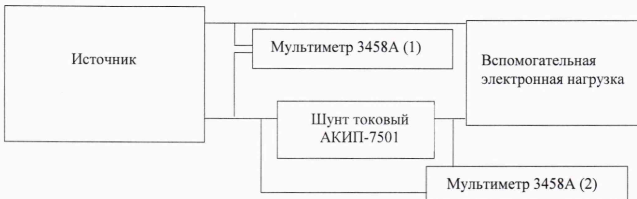
Рисунок 3 - Структурная схема определения нестабильности выходного напряжения постоянного тока, вызванной изменением силы тока в нагрузке, и нестабильности силы выходного тока, вызванной изменением напряжения на нагрузке
