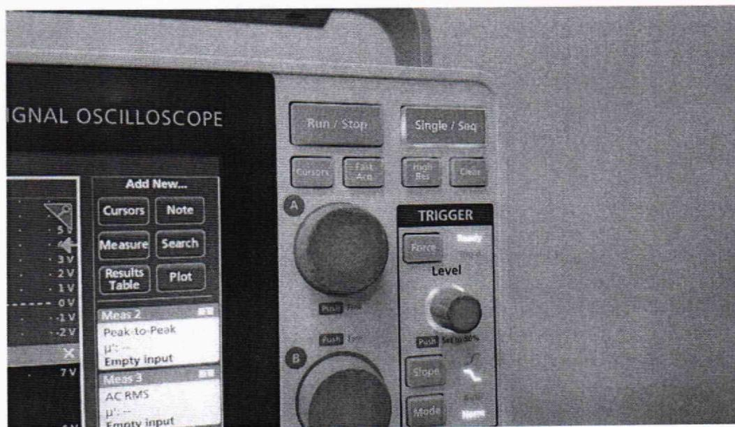
Рисунок 13 - Кнопка пуска регистрации сигналов «Single/Seq»
