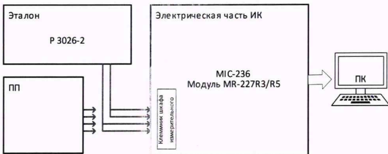
Рисунок 17 – Схема поверки ИК температуры жидкостей и газов поэлементным способом
