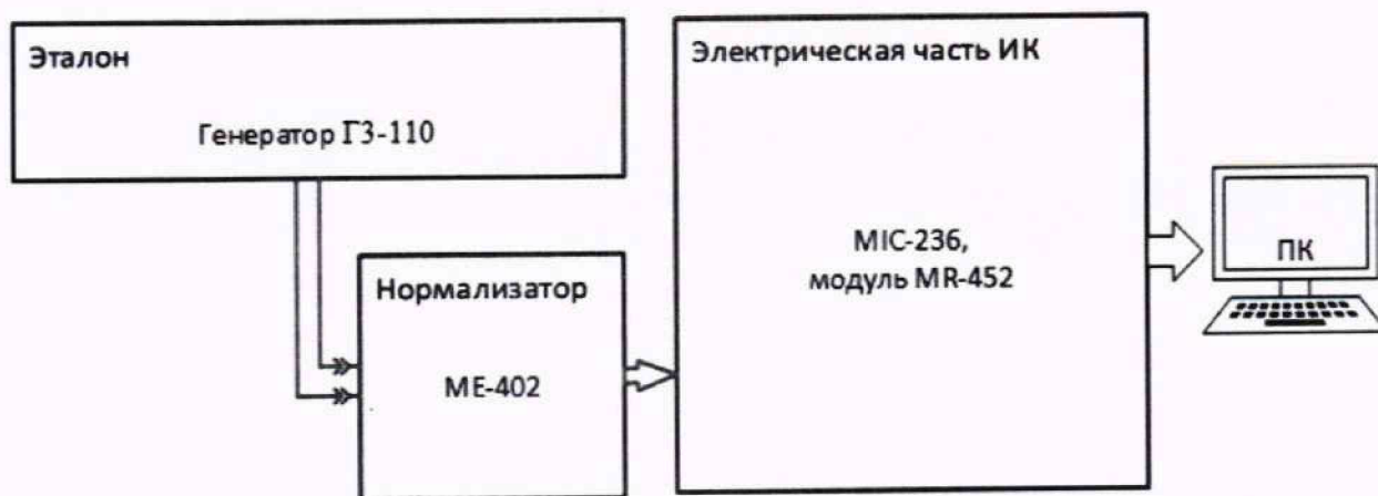
Рисунок 24 – Схема поверки ИК частоты переменного тока генератора
