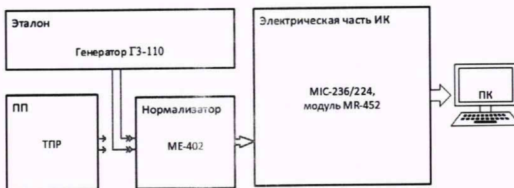
Рисунок 25 – Схема поверки ИК объемного расхода (прокачки) жидкостей
