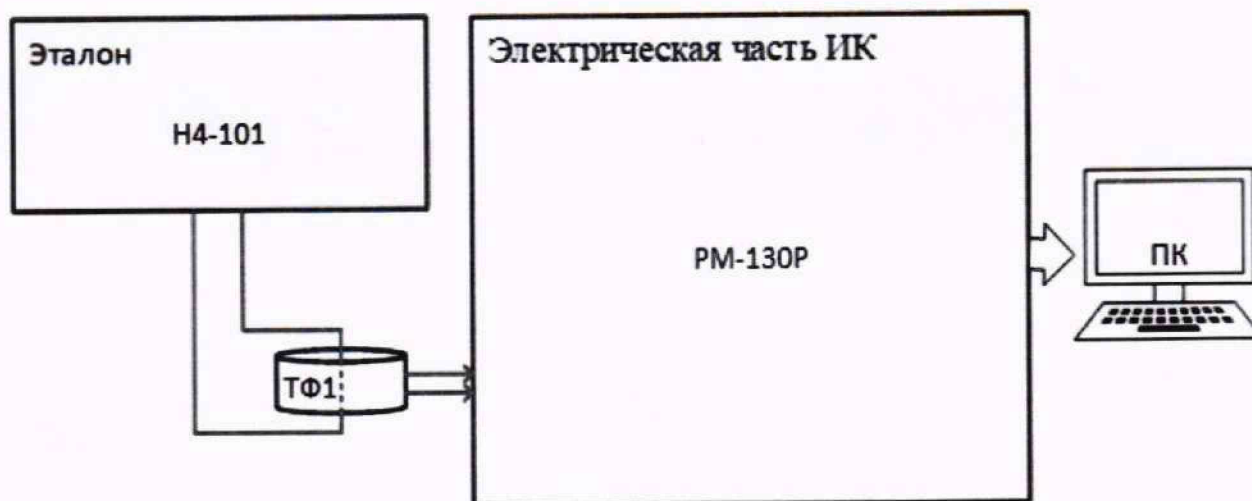
Рисунок 29 – Схема поверки ИК силы переменного тока
