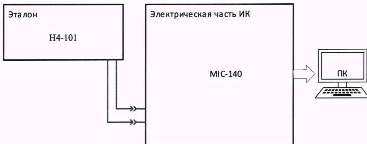
Рисунок 18 – Схема поверки напряжения постоянного тока, соответствующего температуре
