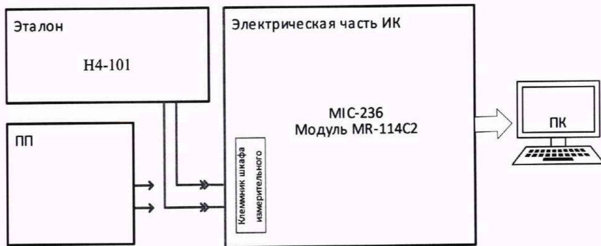
Рисунок 20 – Схема поверки ИК давления газов и жидкостей поэлементным способом
