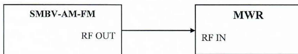
Рисунок 6 – Структурная схема соединения СИ для определения абсолютной погрешности измерений коэффициента амплитудной модуляции
