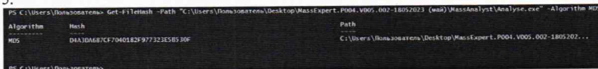
Рисунок 3 – Результат вычисления контрольной суммы метрологически значимого файла Analyse.exe
