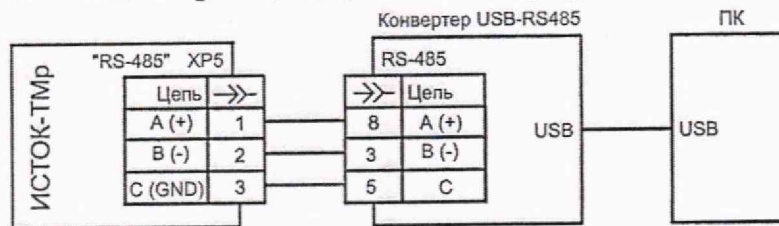
Рисунок 6.1 Схема подключения расширителя ИСТОК–ТМР к ПК
