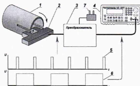
1 – щелевая насадка; 2 – оптопара; 3 – ФБС; 4 – частотомер;
