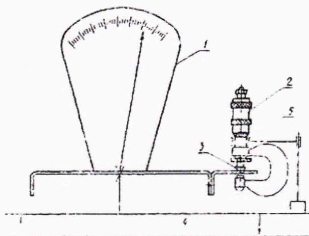
1 - циферблатные весы; 2 - микрометр; 3 - вставка с плоской или цилиндрической поверхностью; 4 - стол; 5 - устройство для крепления микрометр
