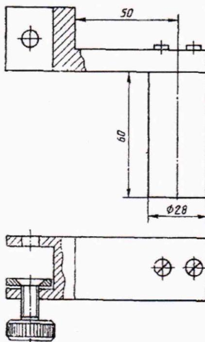
СХЕМА ОПРЕДЕЛЕНИЯ ИЗМЕРИТЕЛЬНОГО УСИЛИЯ МИКРОМЕТРА
