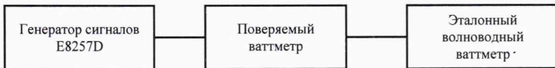
Рисунок 3 – Схема измерений для определения относительной погрешности измерений мощности
