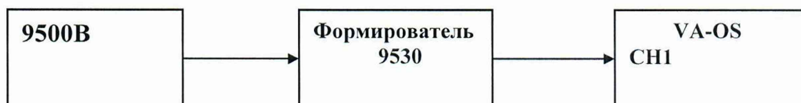
Рисунок 1 – Структурная схема соединения СИ для определения относительной погрешности измерения импульсного напряжения
