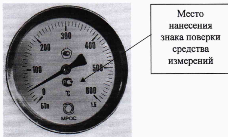
Рисунок 1 – Место нанесения на корпус термометров знака поверки
