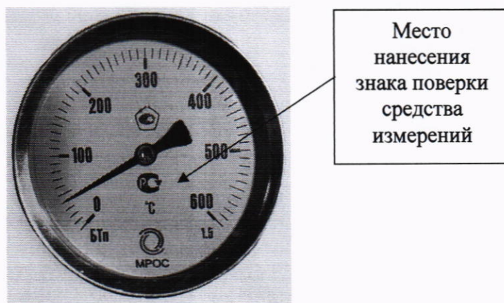
Рисунок 1 – Место нанесения на корпус термометров знака поверки
