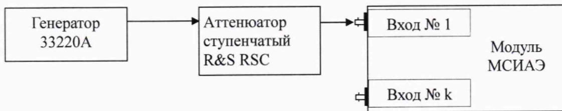
Рисунок А2 – Схема подключения приборов для определения неравномерности амплитудно-частотной характеристики в рабочем частотном диапазоне, определения диапазона и абсолютной погрешности измерения амплитуды входных сигналов
