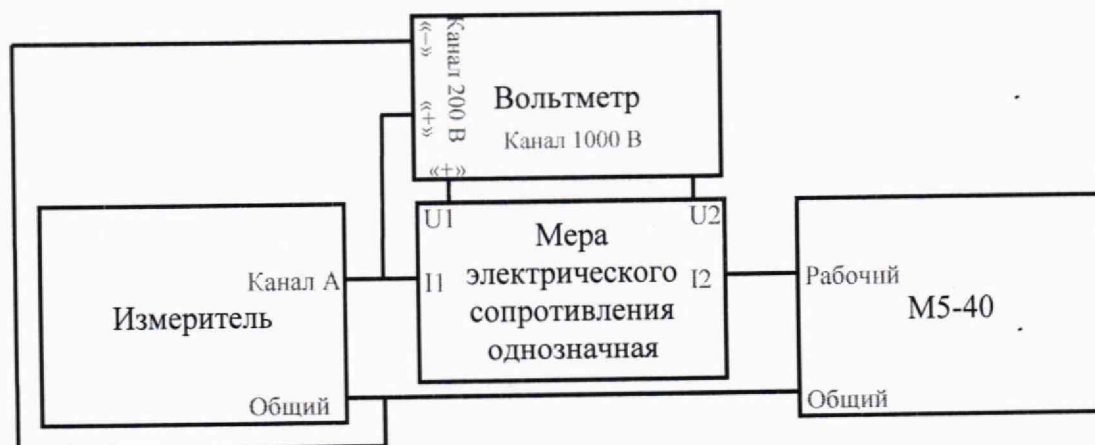
Рисунок 3 – Схема измерений относительной погрешности установки сопротивления
