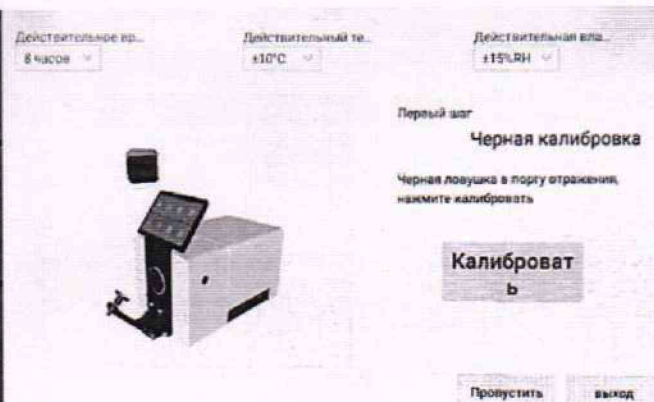
Рисунок 3 - Экран процедуры калибровки «нуля»
