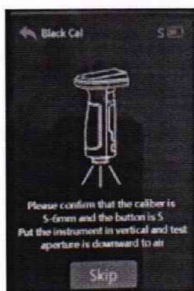
Рисунок 7 - Окно калибровки «нуля» моделей DS-700D и DS-700C
