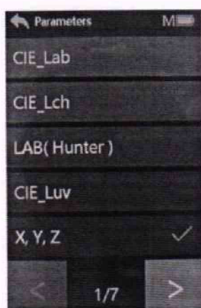
Рисунок 15 - Меню выбора колориметрической системы спектрофотометров моделей DS-700D и DS-700C
