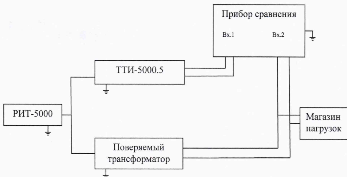
Рисунок 1 – Схема определения токовых и угловых погрешностей трансформаторов
