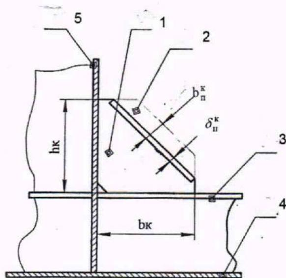
1 – стенка кницы; 2 – полка кницы (отогнутый фланец); 3 – полка рамного набора (таврового профиля); 4 – обшивка днища; 5 – обшивка переборки;  $b_{п}^k$ ,  $\delta_{п}^k$  – ширина и толщина кницы полки;  $h_k$ ,  $b_k$  – высота и ширина кницы.
