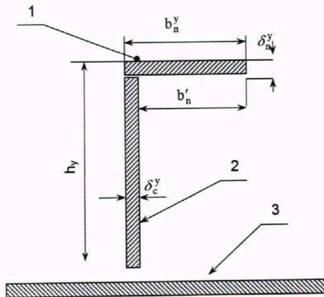
1 – полка профиля; 2 – стенка профиля; 3 – обшивка днища;  $b_n^y$  – ширина полки;  $\delta_c^y$  – толщина стенки профиля;  $h_y$  – высота стенки профиля.
