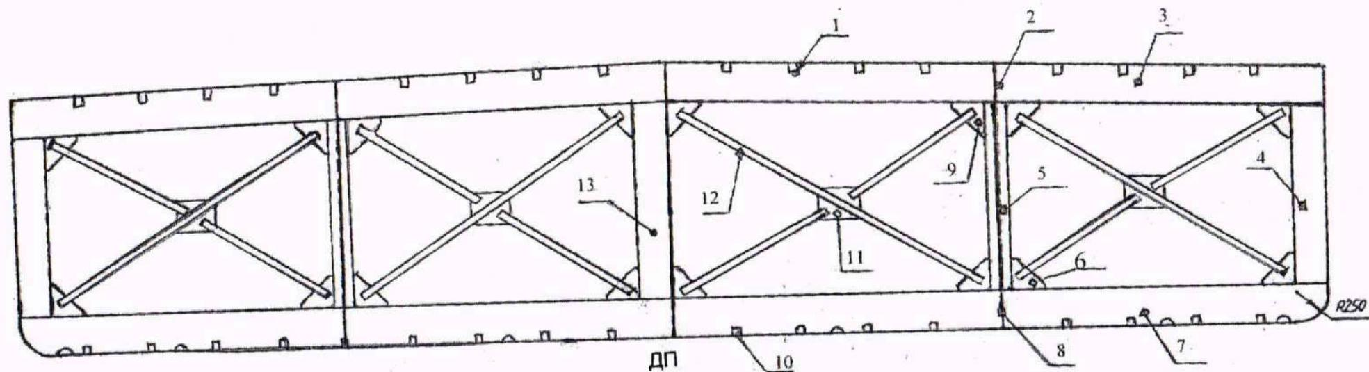
3, 4, (13), 7 – элементы поперечного рамного набора (бимс, рамные стойки, флор); 2, 8 – элементы продольного рамного набора (карлинес, кильсон); 1, 10 – элементы продольного холостого набора; 5 – пиллерс; 6, 9, 11 – кницы; 12 – раскаты; ДП – продольная диаметрально переборка.
