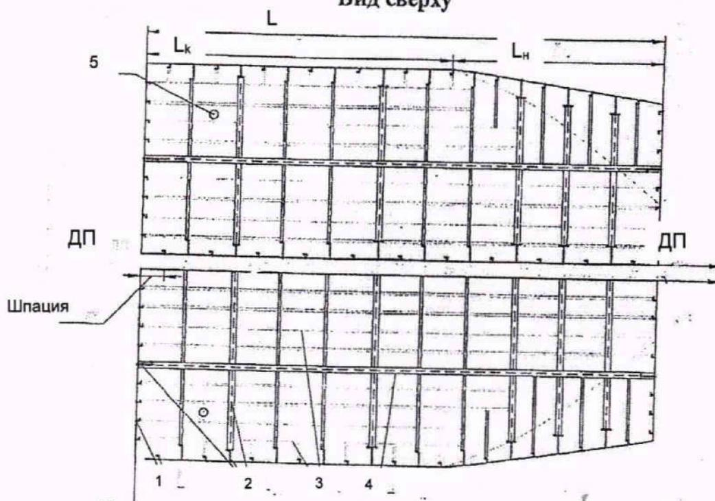
1 – вертикальный холостой набор (набор борта, переборки); 2 – поперечный рамный набор (флоры, шпангоуты, бимсы); 3 – продольные ребра жесткости днища и палубы; 4 – продольный рамный набор (кильсоны, карлингсы); 5 – измерительная труба; L – длина танка;  $L_n$  – длина носовой части танка;  $L_k$  – длина кормовой части танка.
