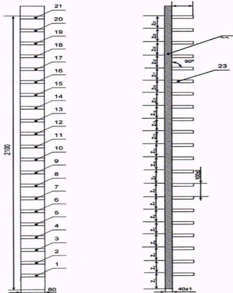
1-21, 23 – перекладины деревянные; 22 – брусок деревянный;  $Z_1, Z_2, \dots, Z_i, \dots, Z_{21}$  – расстояния между перекладинами, равные 100 мм.
