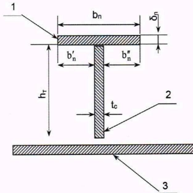
1 – полка профиля; 2 – стенка профиля; 3 – стенки танка (борта, днища, продольной диаметральной переборки);  $b_n$  – ширина полки профиля;  $t_c$  – толщина стенки профиля;  $h_r$  – высота стенки профиля;  $\delta_n$  – толщина полки профиля.
