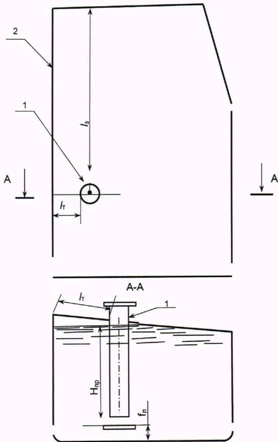
1 – измерительная труба; 2 – продольная диаметральной переборка;  $l_3$  – координата точки измерений базовой высоты танка и уровня жидкости;  $l_{\tau}$  – расстояние от продольной диаметральной переборки до образующей измерительной трубы;  $H_{пр}$  – предельный уровень градуировки танка;  $f_{л}$  – расстояние от днища танка до дна измерительной трубы.
