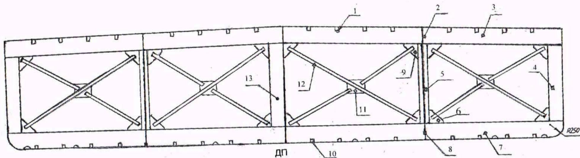
3, 4, (13), 7 – элементы поперечного рамного набора (бимс, рамные стойки, флор); 2, 8 – элементы продольного рамного набора (карлинес, кильсон); 1, 10 – элементы продольного холостого набора; 5 – пиллерс; 6, 9, 11 – кницы; 12 – раскаты; ДП – продольная диаметральной переборка.
