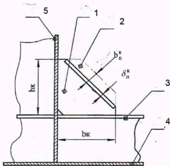
1 – стенка кницы; 2 – полка кницы (отогнутый фланец); 3 – полка рамного набора (таврового профиля); 4 – обшивка днища; 5 – обшивка переборки;  $b_{\text{п}}^k$ ,  $\delta_{\text{п}}^k$  – ширина и толщина кницы полки;  $h_k$ ,  $b_k$  – высота и ширина кницы.
