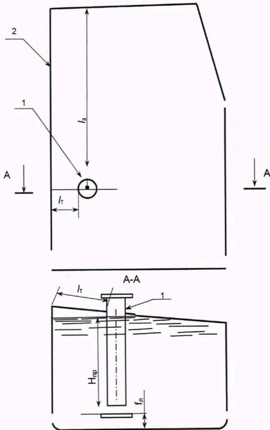
1 – измерительная труба; 2 – продольная диаметральной переборка;  $l_3$  – координата точки измерений базовой высоты танка и уровня жидкости;  $l_T$  – расстояние от продольной диаметральной переборки до образующей измерительной трубы;  $H_{гр}$  – предельный уровень градуировки танка;  $f_l$  – расстояние от дна танка до дна измерительной трубы.
