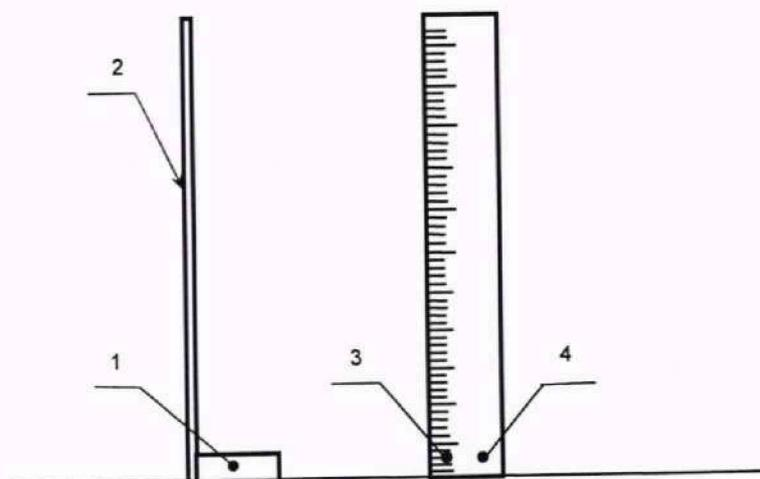
1 – магнитный держатель; 2 – линейка измерительная; 3, 4 – винты крепления линейки.
