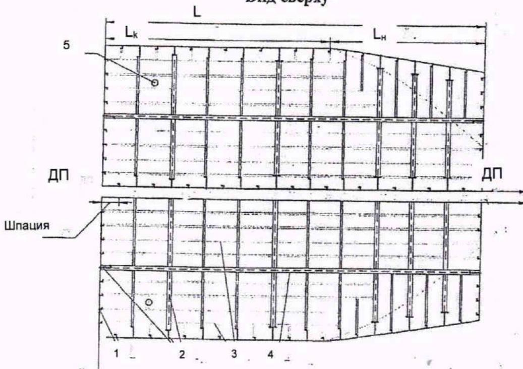
1 – вертикальный холостой набор (набор борта, переборок); 2 – поперечный рамный набор (флоры, шпангоуты, бимсы); 3 – продольные ребра жесткости днища и палубы; 4 – продольный рамный набор (кильсоны, карлингсы); 5 – измерительная труба; L – длина танка;  $L_n$  – длина носовой части танка;  $L_k$  – длина кормовой части танка.
