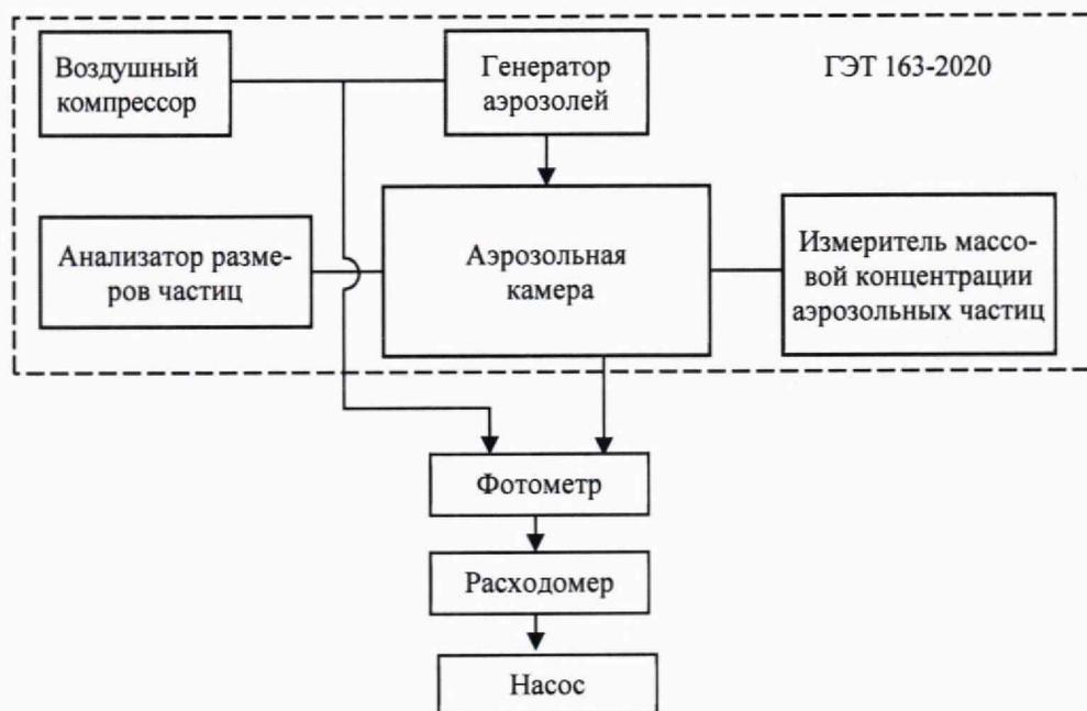
Рисунок 1 – Схема поверки
