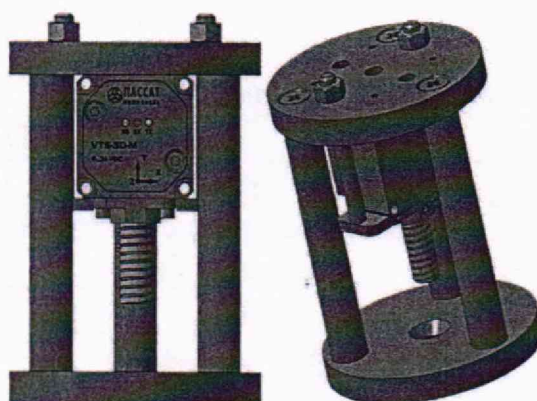
Рисунок 3 – Схема установки датчика в оснастке по измерительной оси Y
