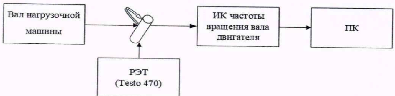
Рисунок 2 - Схема поверки ИК частоты вращения вала двигателя (РЭТ Testo 470)
