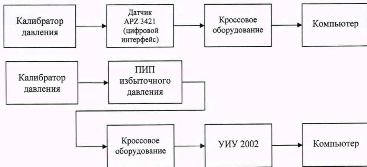
а) Схема определения метрологических характеристик комплектным способом
