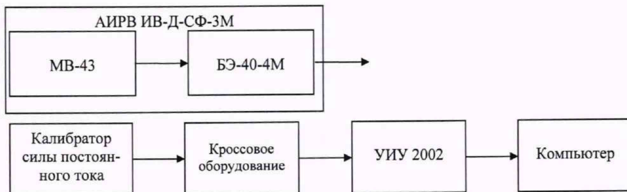
Рисунок 8 - Схема определения метрологических характеристик ИК виброскорости
