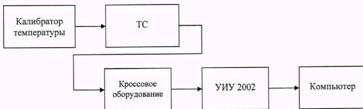
а) Схема определения метрологических характеристик комплектным способом
