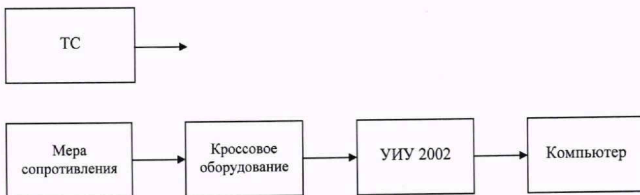
б) Схема определения метрологических характеристик поэлементным способом
