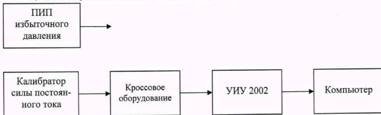
б) Схема определения метрологических характеристик поэлементным способом
