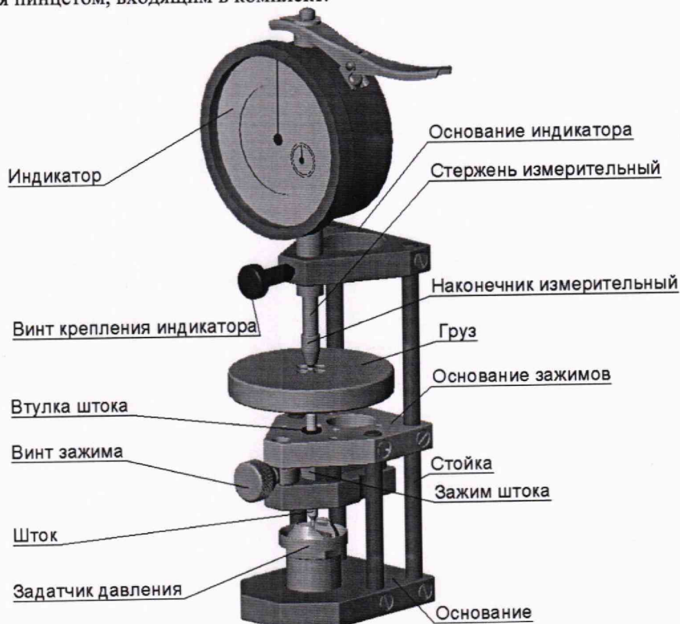
Рисунок 1 - Измерение величины деформации пружины задатчика давления
