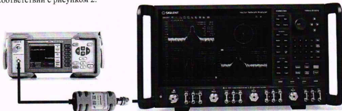
Рисунок 2 – Схема соединения приборов для определения диапазона установки уровня выходной мощности и абсолютной погрешности установки уровня мощности
