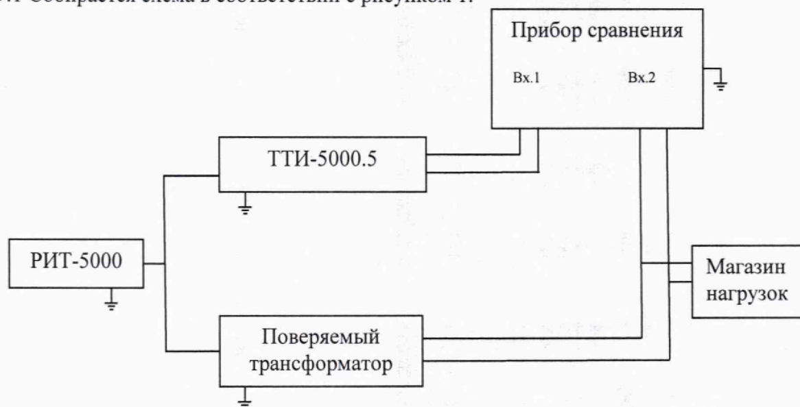
Рисунок 1 – Схема определения токовых и угловых погрешностей трансформаторов
