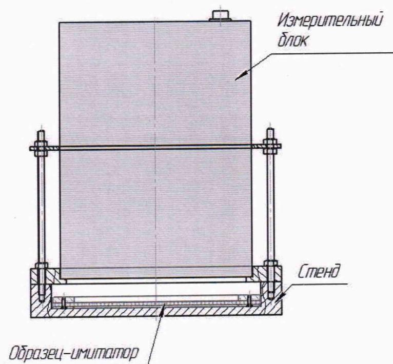
Рисунок 1 – Установка толщиномера и образцов-имитаторов на стенде
