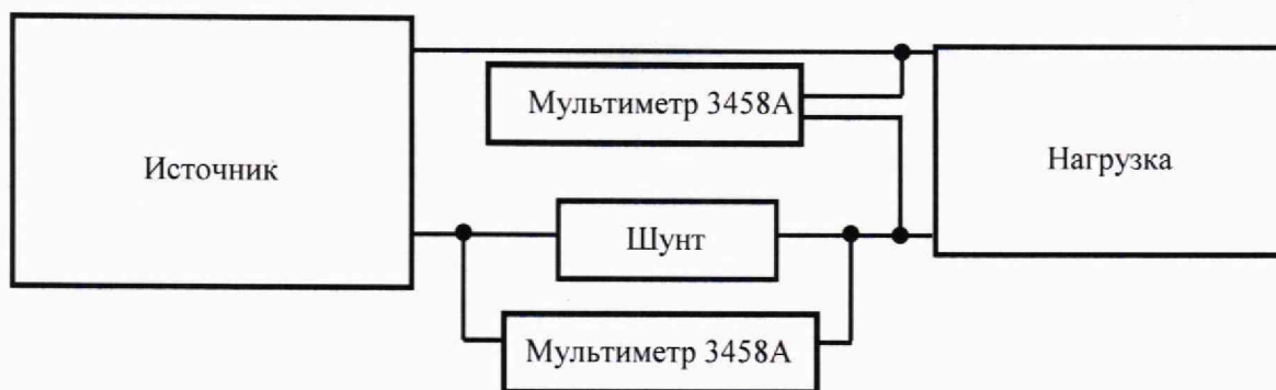
Рисунок 3 - Структурная схема определения абсолютной погрешности установки электрического сопротивления, электрической мощности постоянного тока
