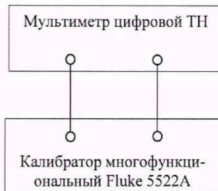
Рисунок 1 – Схема для определения метрологических характеристик
