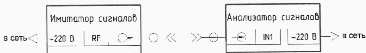
Рисунок 4 — Схема измерений для определения относительного уровня помех, обусловленного паразитными составляющими
