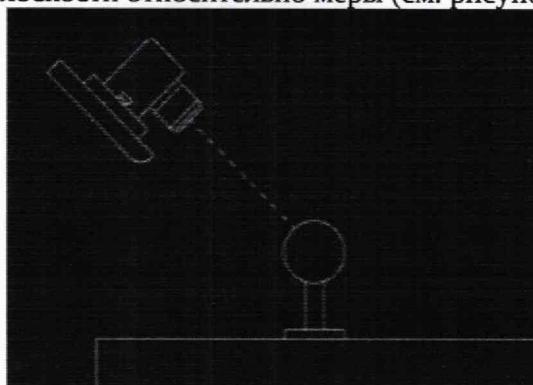
Рисунок 1 – Схема расположения меры относительно сканера
