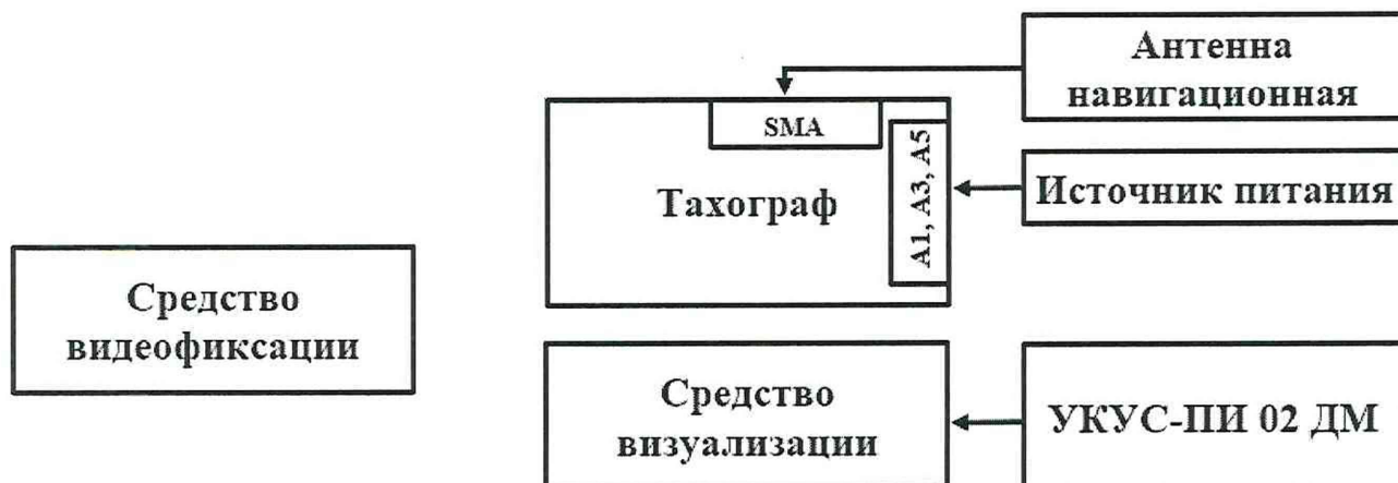
Рисунок 4 – Схема проведения измерений при определении абсолютной погрешности синхронизации шкалы времени внутреннего опорного генератора тахографа со шкалой времени блока СКЗИ
