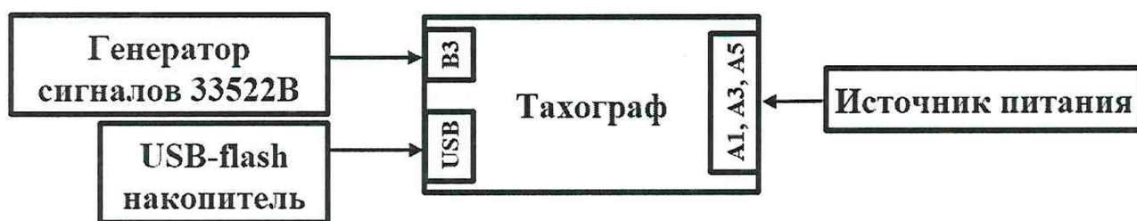
Рисунок 3 – Схема проведения измерений при определении абсолютной инструментальной погрешности измерений скорости по датчику движения
