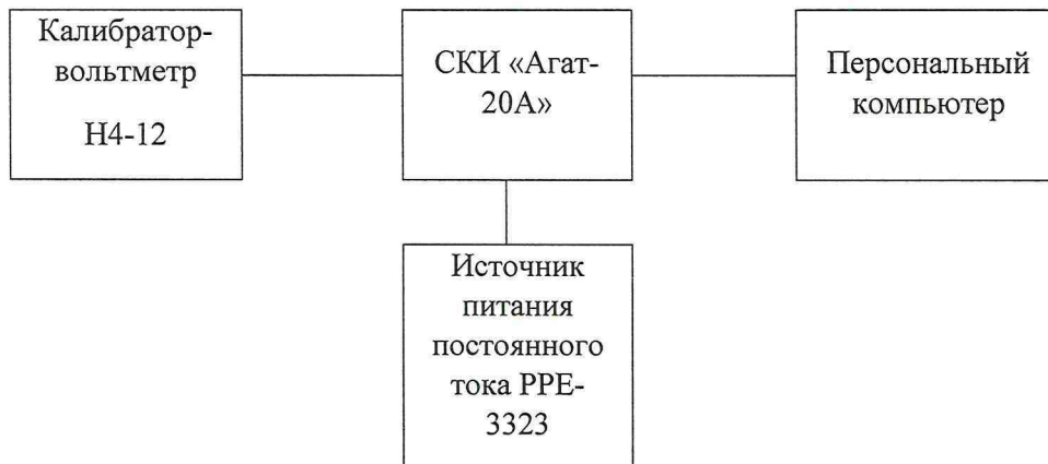
Рисунок 1– Схема подключения для определения приведенной погрешности систем СКИ «Агат-20А»
