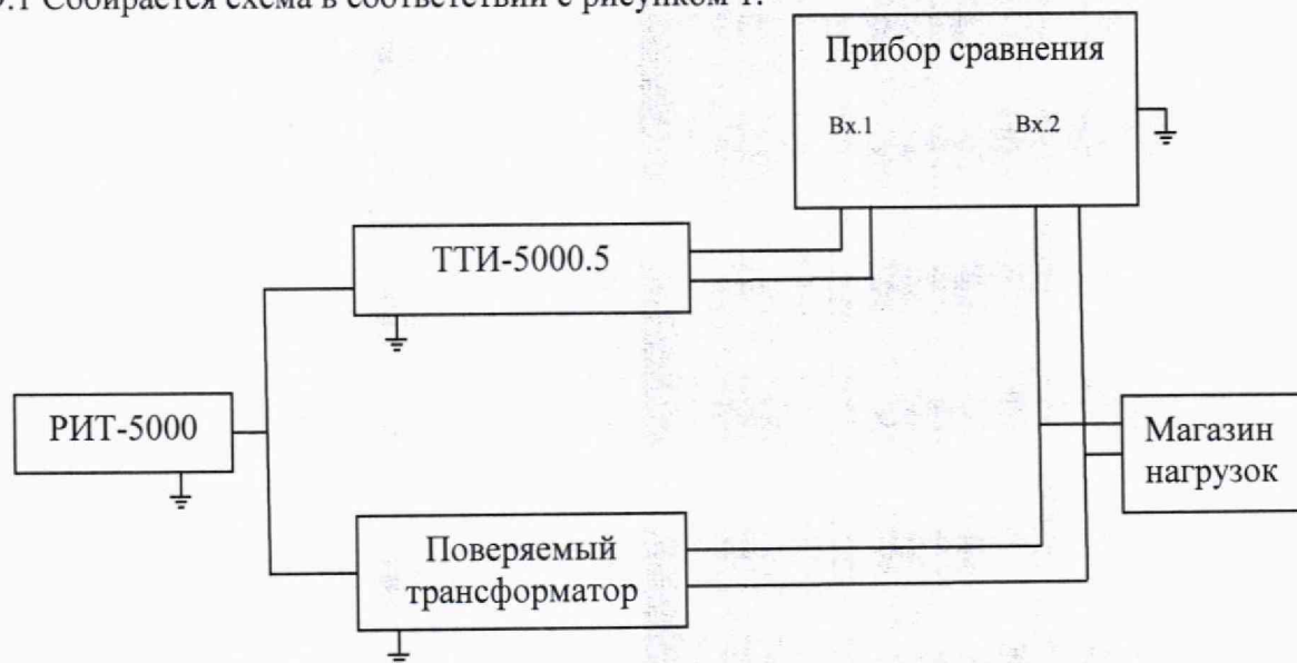
Рисунок 1 – Схема определения токовых и угловых погрешностей трансформаторов
