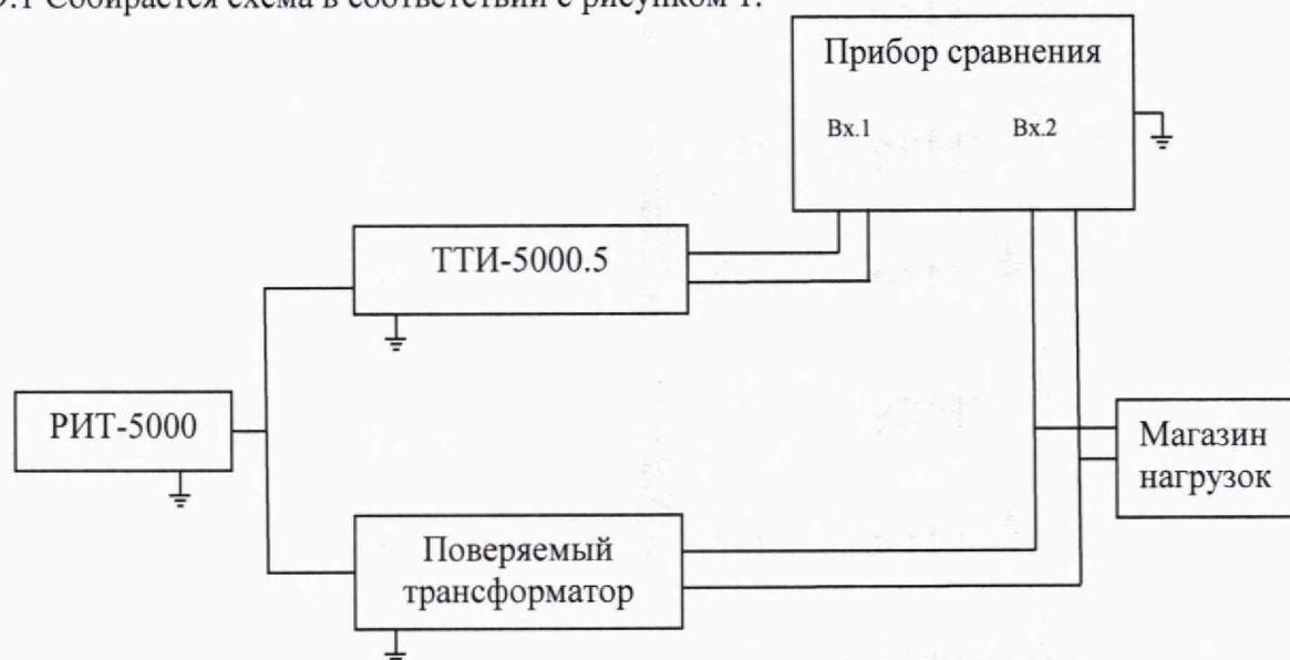
Рисунок 1 – Схема определения токовых и угловых погрешностей трансформаторов
