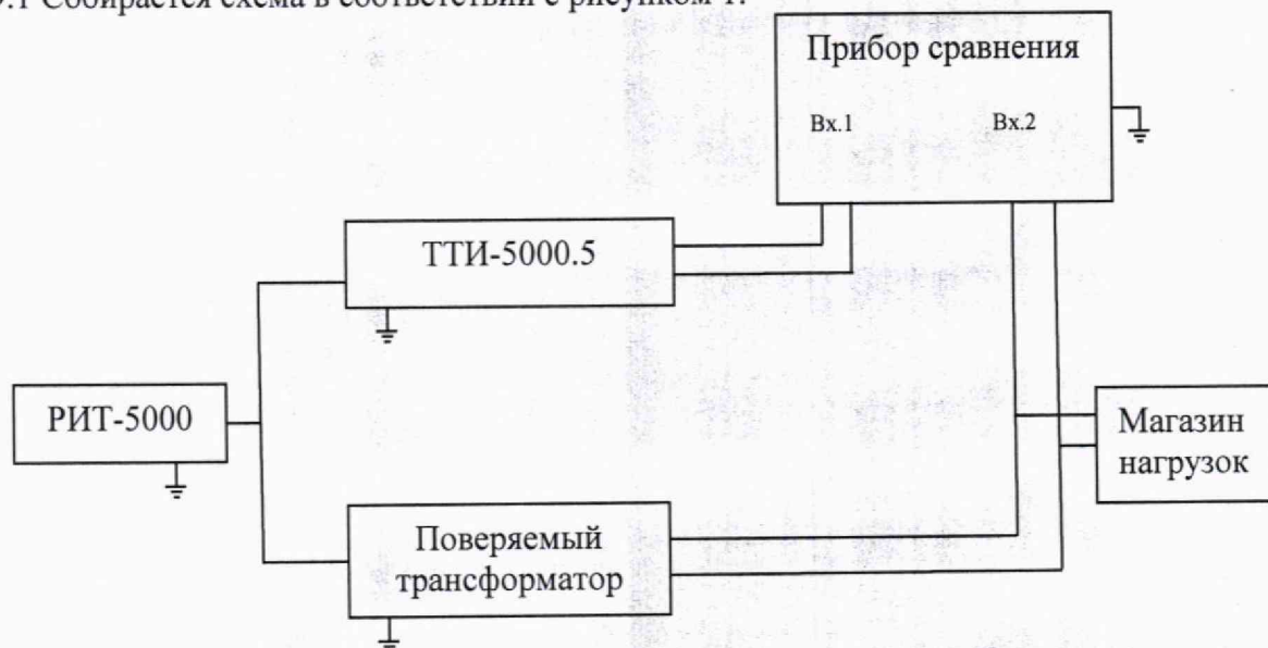
Рисунок 1 – Схема определения токовых и угловых погрешностей трансформаторов
