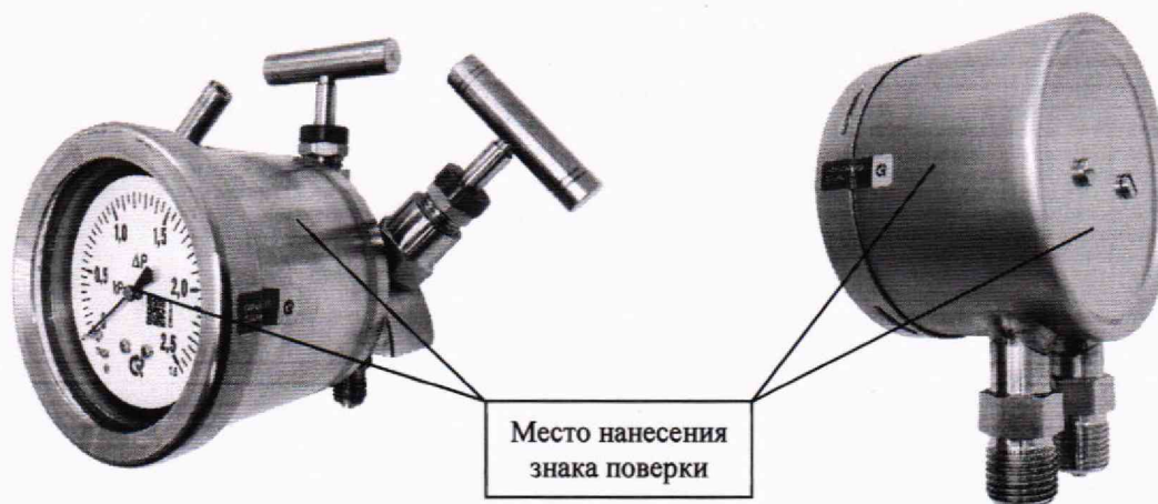
Рисунок 1 – Обозначение возможных мест нанесения знака поверки
