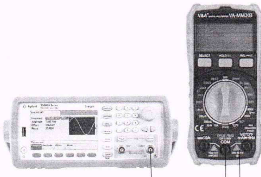
Рисунок 3 – Схема подключений для определения абсолютной погрешности измерений частоты переменного тока (положение поворотного переключателя режимов работы мультиметров показано условно)
