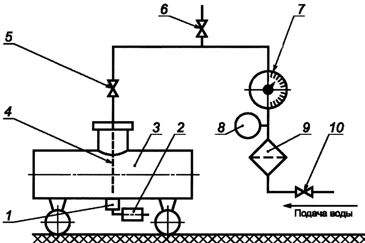
1 — нижний (донный) клапан; 2 — гидросистема слива; 3 — полуприцеп-цистерна; 4 — шланг; 5, 6 — краны; 7 — счетчик жидкости; 8 — манометр; 9 — фильтр; 10 — вентиль.
