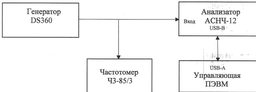
Рисунок 4 – Блок-схема определения минимальной ширины полосы пропускания измерительного фильтра.
