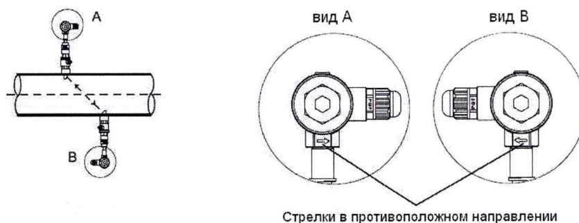
Рисунок 4 – Регулировка направления передачи сигнала
