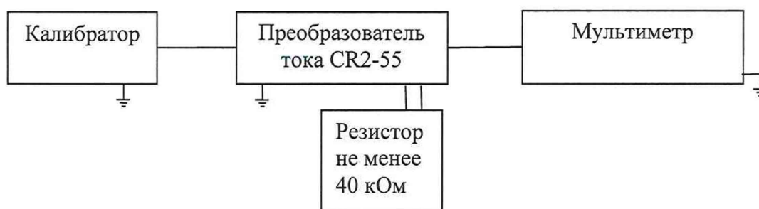
Рисунок 2 - Схема поверки при первичных токах до 50 А
