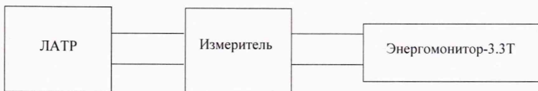
Рисунок 1 – Структурная схема определения абсолютной погрешности измерений воспроизведенных значений напряжения переменного тока
