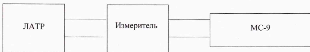
Рисунок 5 – Структурная схема определения абсолютной погрешности измерений силы переменного тока (тока утечки)
